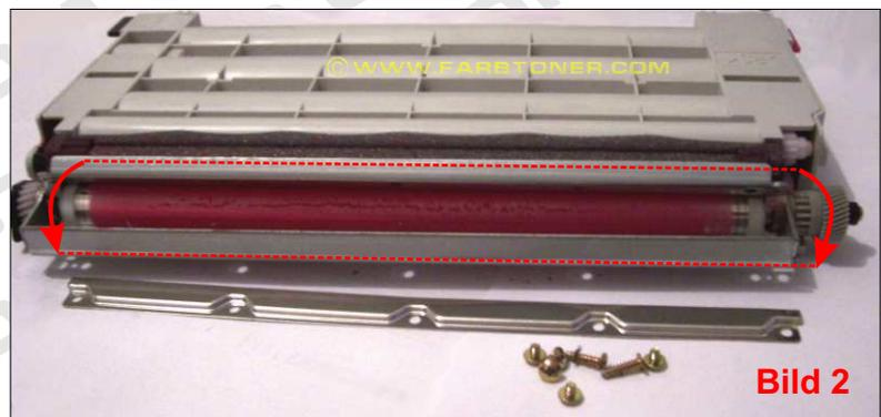
3) Entfernen Sie die Metalleinheit mit der Tonerträgerwalze. Vorsicht, schütteln Sie die Kartusche nicht, damit der Toner nicht herausfällt (Bild 3)
