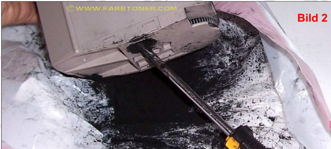
1) Nehmen Sie einen Müllbeutel und halten Sie die Kartusche vorsichtig mit dem blauen Hebel nach oben über die Mülltüte. Nehmen Sie einen Schraubenzieher in die andere Hand und drücken Sie auf die Klappe der Resttonerkammer. Schütteln Sie die Kartusche leicht, sodaß der Resttoner in den Müllbeutel fallen kann. (Bild 2)
