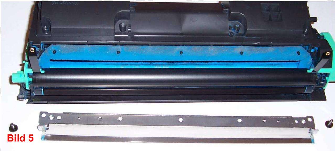
Schritt 7: Setzen Sie jetzt Ihre Kartusche in umgekehrter Reihenfolge wieder zusammen. Füllen Sie den neuen Toner in die Öffnung (Bild 6) und verschließen Sie diese anschließend mit dem Stöpsel. Sollte der Stöpsel beschädigt worden sein und nicht mehr dicht verschließen, können Sie bei uns neue Stöpsel erwerben oder Sie können auch den Öffnungsrand mit einem Kunststoffkleber anstreichen und den Stöpsel hineinstecken.
