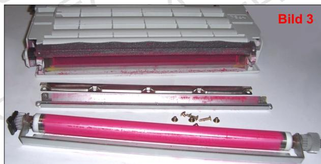
4) Reinigen Sie die Tonerträgerwalze und das Verteilmesser (kleine Metallschiene, die von Innen an der Metalleinheit befestigt ist und direkt an der Walze anliegt) vorsichtig mit einem Papiertuch. (Vorsicht!) Fassen Sie die Trägerwalze nicht mit den Händen an, damit keine Fettflecken entstehen. (Bild 4)
